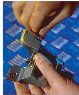
Pro usnadnění nastavení průměru je možné použít dvounožové hlavičky se synchronizovaným seřizováním nožů, kde seřizováním jednoho nože se zároveň seřizuje i druhý nůž.
